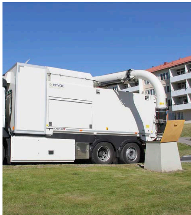
Mobil sopsug kopplad till en upphöjd dockningspunkt. FOTO: TOMAS THERNSTRÖM, RAMBOLL
