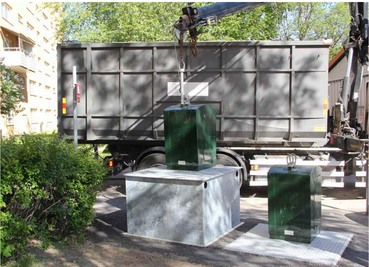
Tömning av underjordsbehållare. FOTO: TOMAS THERNSTRÖM, RAMBOLL
